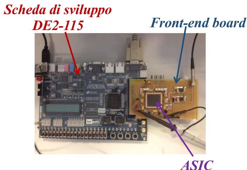
Figura 4.1: Setup utilizzato per il collaudo dell'ASIC
