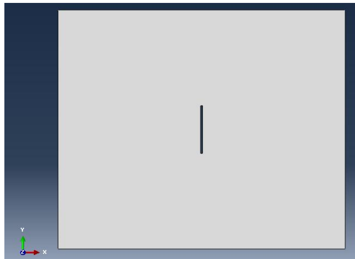
Fig 3.3 Particolare dello skin con una cricca
