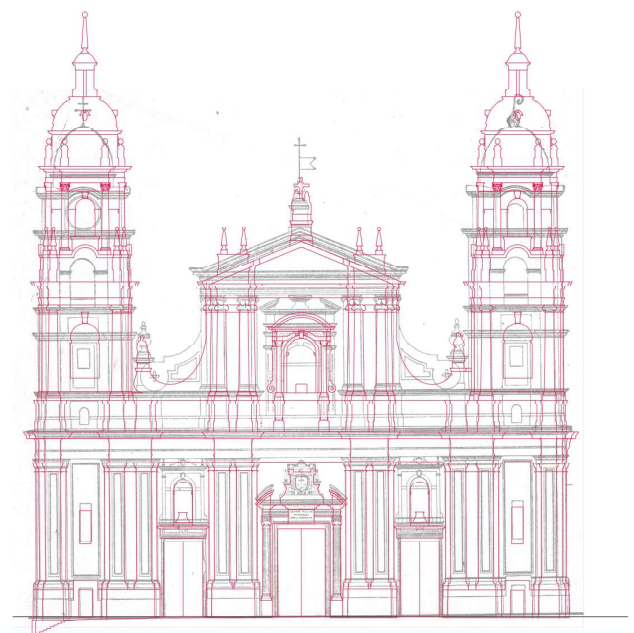
Fig. 28. Comparación entre los planos de proyecto y la realidad construida de la fachada conservada hasta 1948, y la fachada actual de la Catedral (Autor, 2025).
