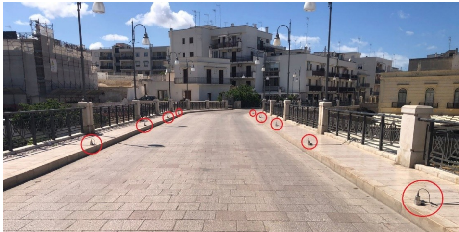
Figura 5.8: Posizione accelerometri sul marciapiede
