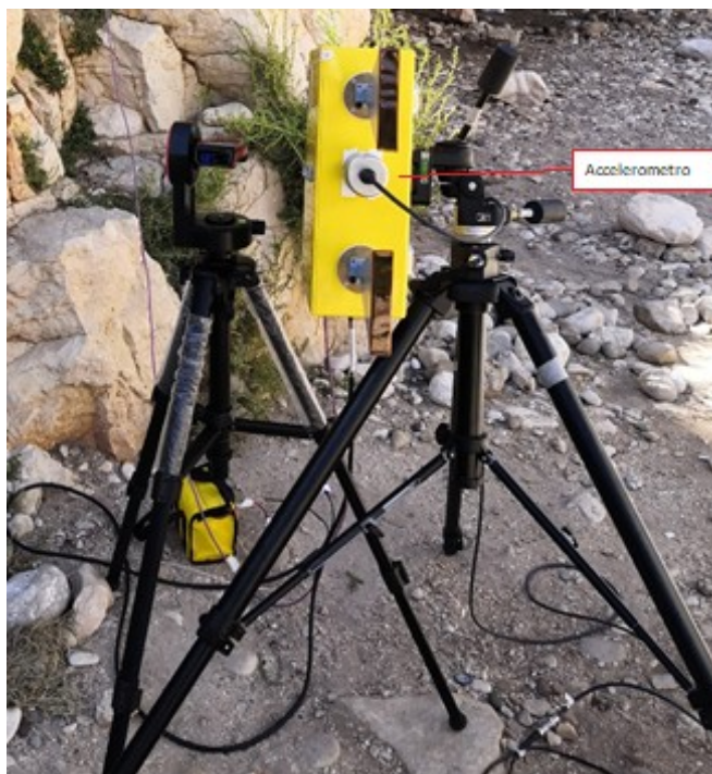
Figura 5.20: Accelerometro per la misurazione delle frequenze proprie dell'IBIS
