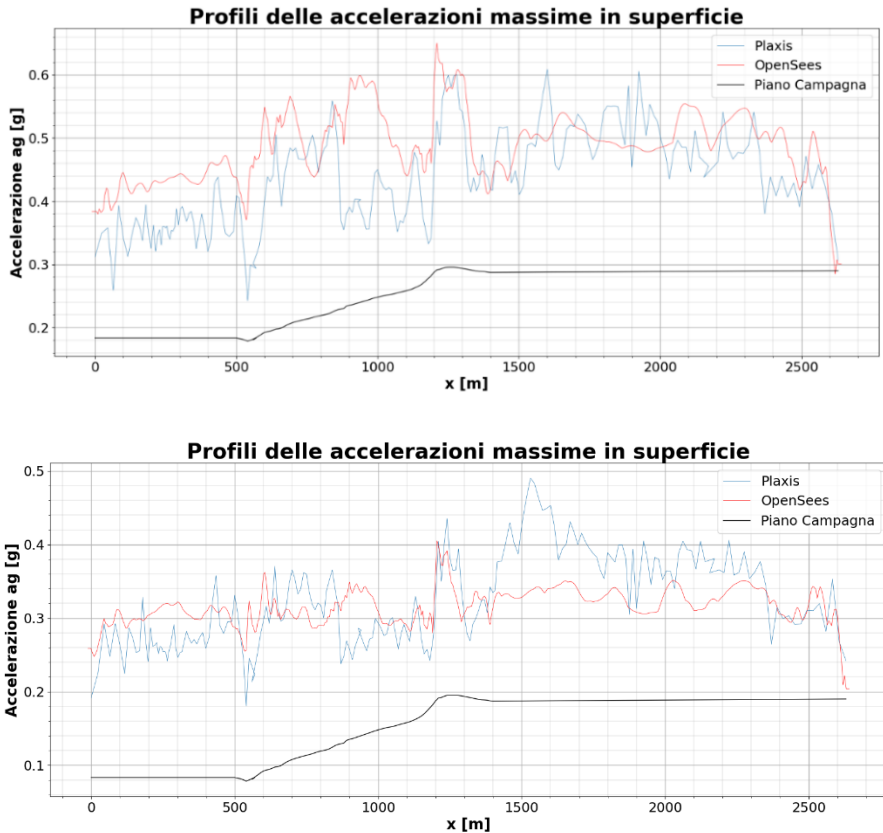
Fig. 50 Confronto dei profili di accelerazione massima in superficie
