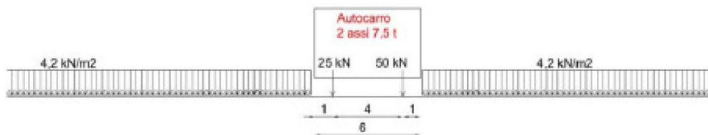
Figure 33 - Light traffic load model conforming to the Italian Road Code, a possible distribution (Consiglio Superiore dei Lavori Pubblici (CS.LL.PP.), 2020).
