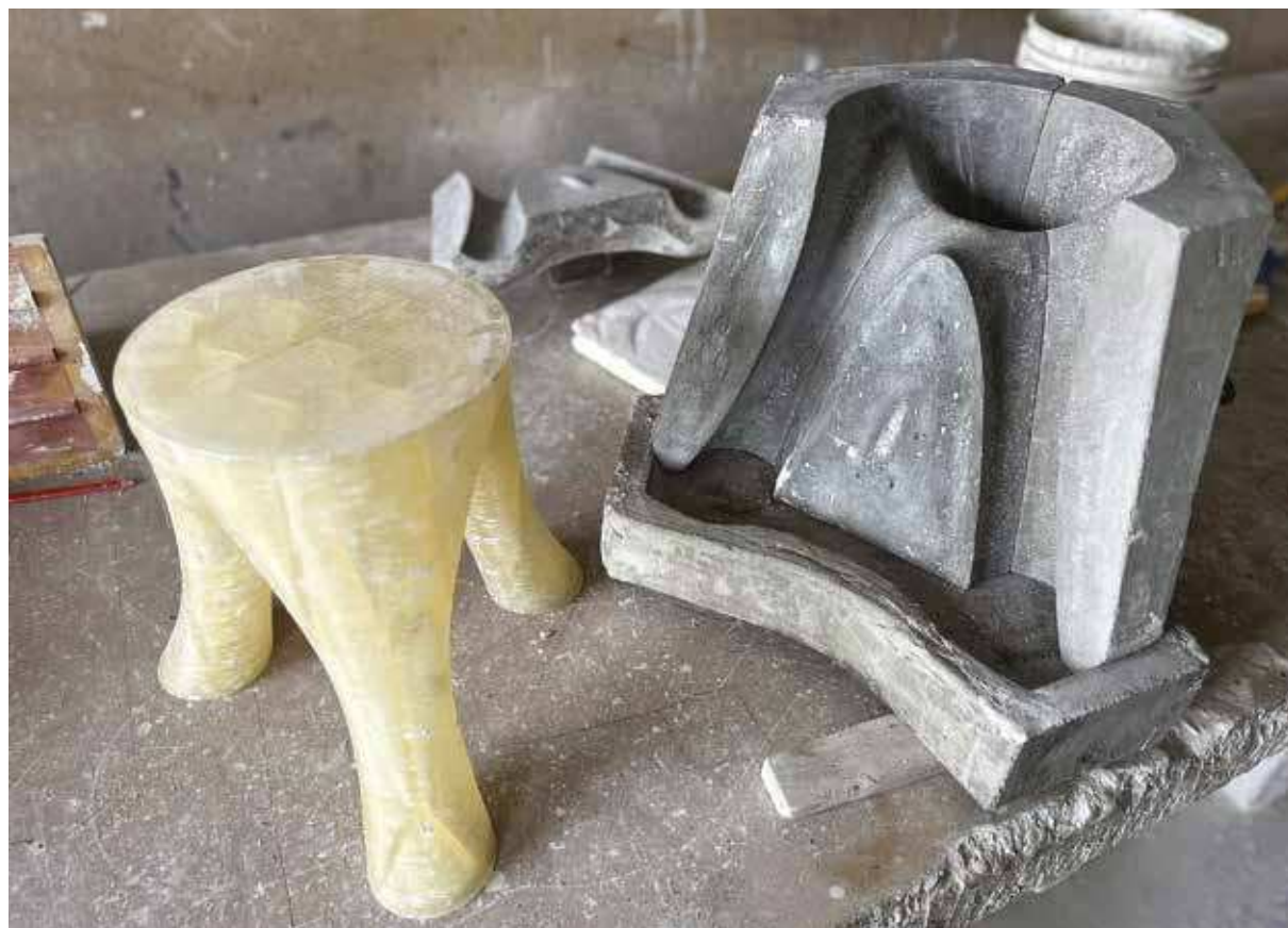
Fig. 54. Forma stamata in PLA e calco in cemento da essa ottenuto per la realizzazione del modulo di una parete portabottiglie progettata da Giuseppe Fallacara (© Giuseppe Fallacara).
