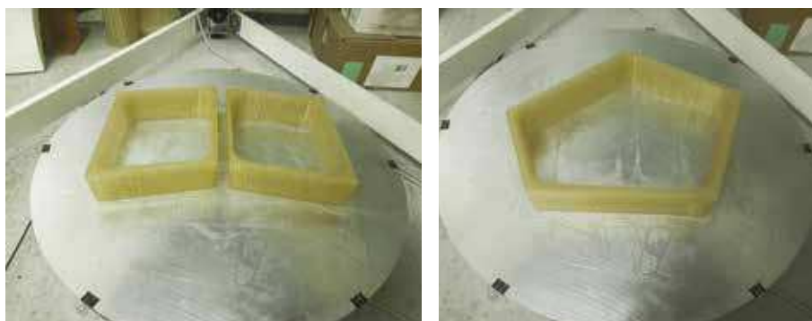
Figg. 175-176. Due conci quadrangolari e un conico pentagonale sul piatto di stampa.
