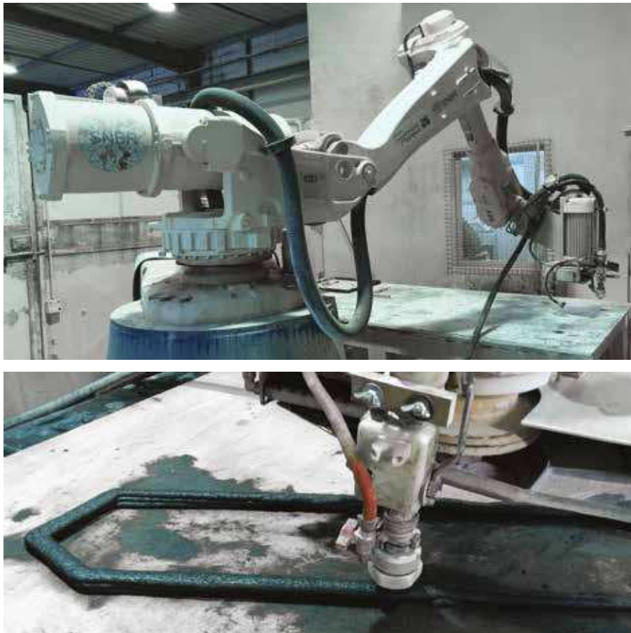
Fig. 17. La sperimentazione di stampa con malta geopolimerica: in alto il braccio robotico utilizzato per la sperimentazione e in basso la stampa di un provino (© Giuseppe Fallacara).
