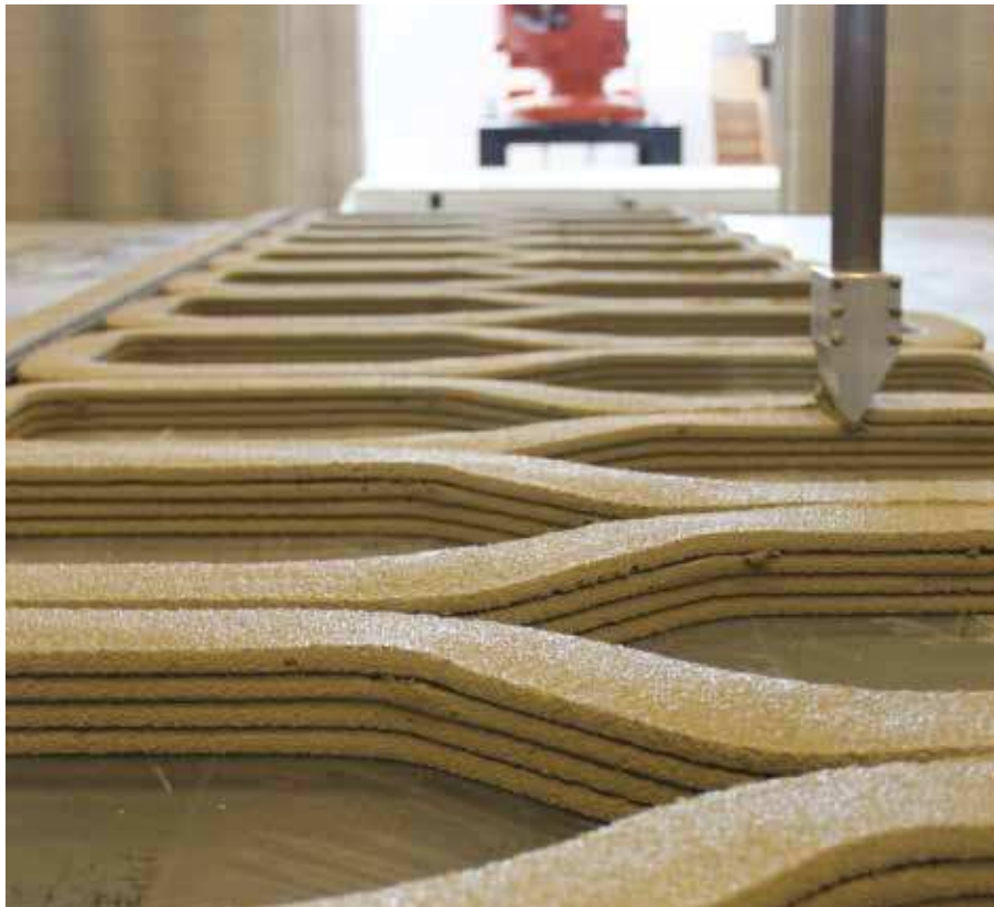
Fig. 50. Fase di stampa di uno dei blocchi del Nijmegen Bridge (© Zavhy).
