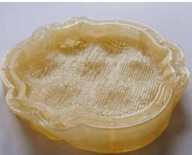
Fig. 84-85 (in basso). Fotografie del primo provino stampato, in cui è evidente il cedimento dei layer per via degli sbalzi eccessivi della geometria.
