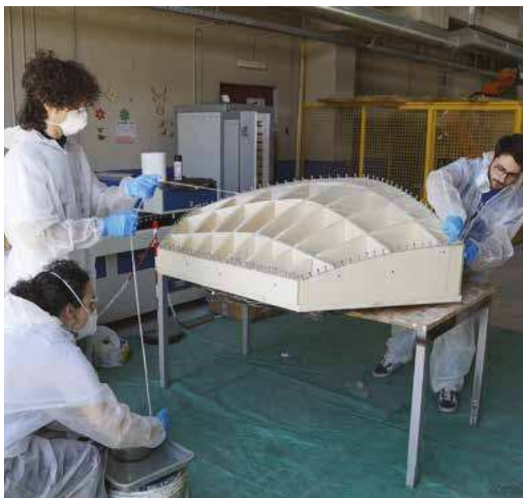
Figg. 173-174. La tessitura di una delle porzioni pentagonali in fibra (a sinistra) e pezzo finito (a destra).
