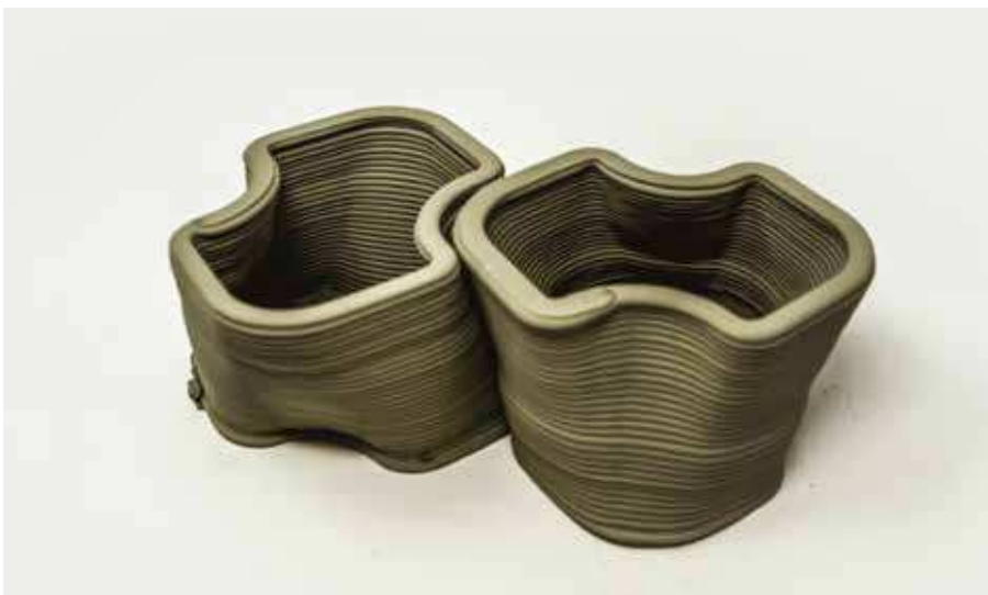
Figg. 134-138. Fotografie di alcuni conci stampati. In particolare, nelle immagini in alto è possibile notare errori legati al ritiro di materiale (fondo non completamente pieno) o a variazioni impreviste della viscosità dell'impasto.
