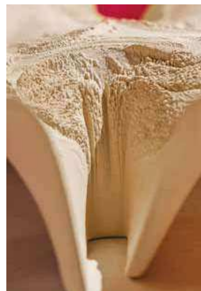
Figg. 40-41. Modello in scala di TechnoVault, progettato da Dustin White e stampato dall'azienda Concr3de con tecnologia binder jetting usando polveri di pietra leccese. Il modello è stato esposto presso la mostra Marmomac Meets Academies 2023 (© Gaz Blanco).
