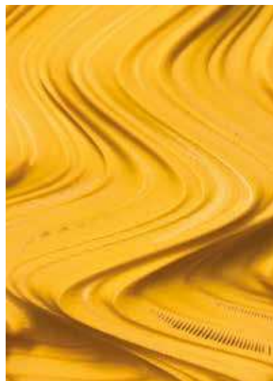
Figg. 36-37. Modello in PLA stampato con tecnologia FDM.
