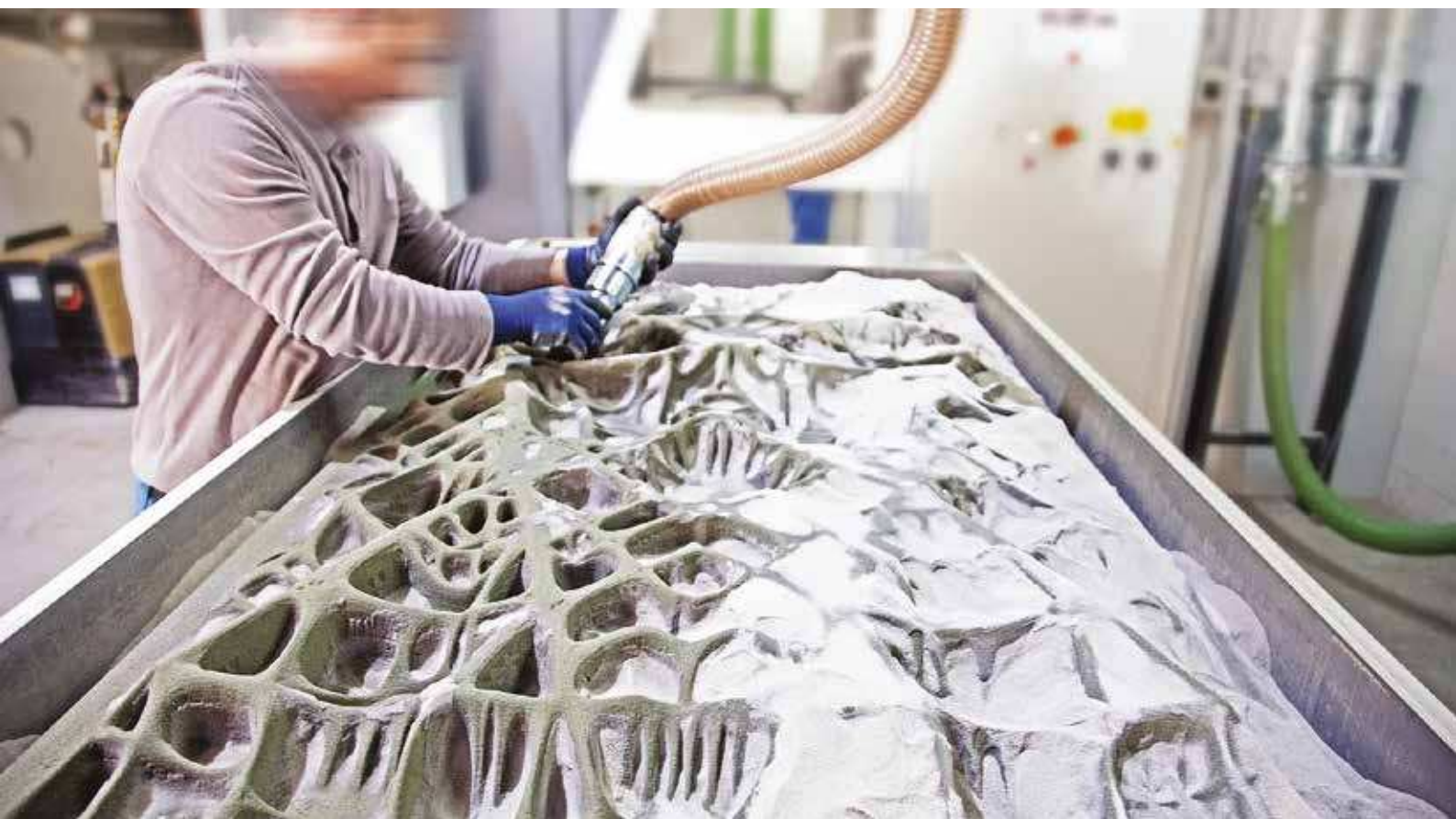
Fig. 53. Rimozione della polvere inerte inutilizzata da una cassaforma stampata con tecnologia binder jetting (© ETH Zürich).
