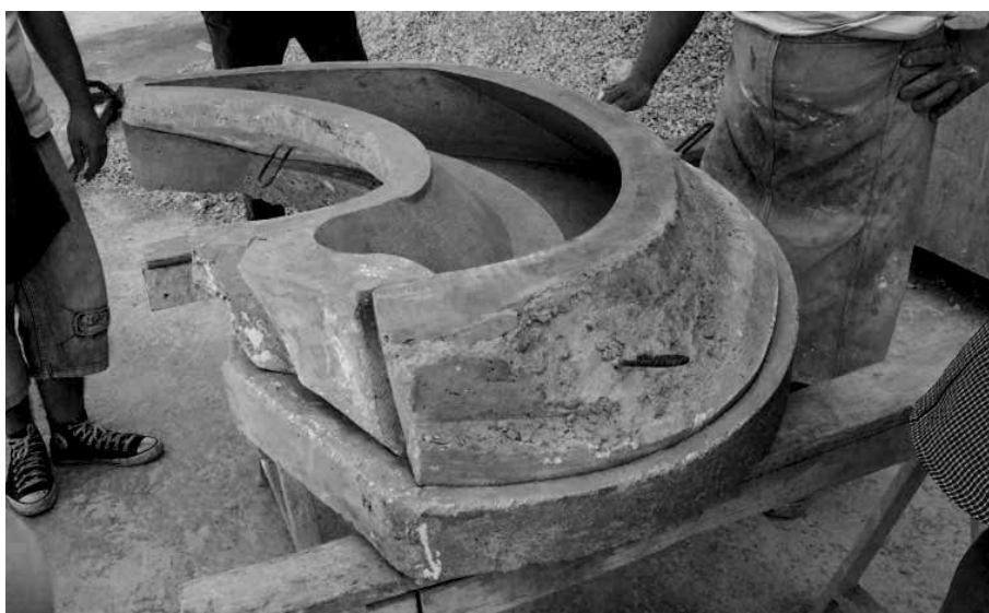
Fig. 58. Lo stampo utilizzato per realizzare il gradino della scala E.L.I.C.A. in pietra ricomposta (© Giuseppe Fallacara).
