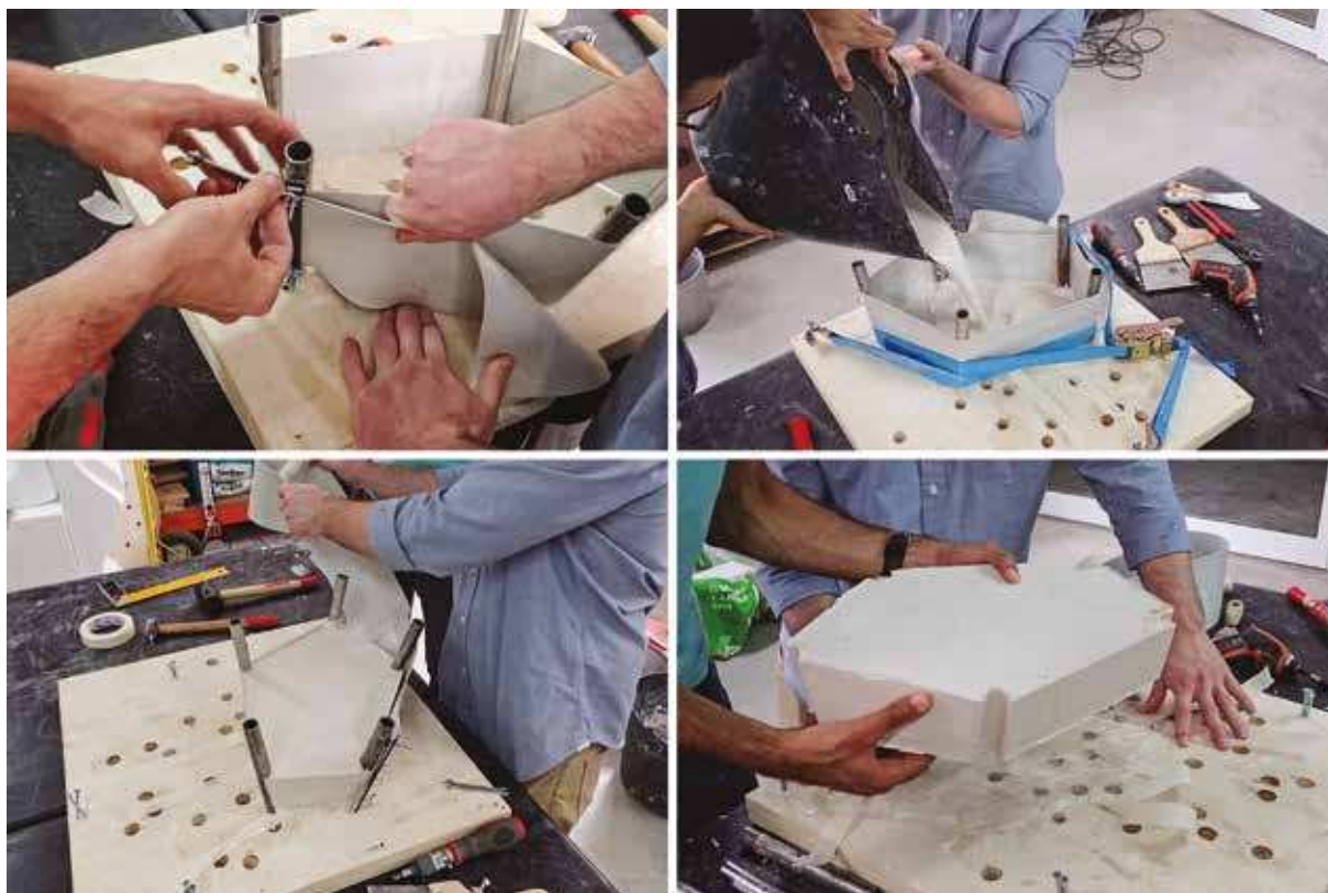
Figg. 59-62. Il metodo messo a punto da Varela e Sousa per la realizzazione di conci poligonali in pietra ricomposta (© Pedro De Azambuja Varela, José Pedro Sousa).
