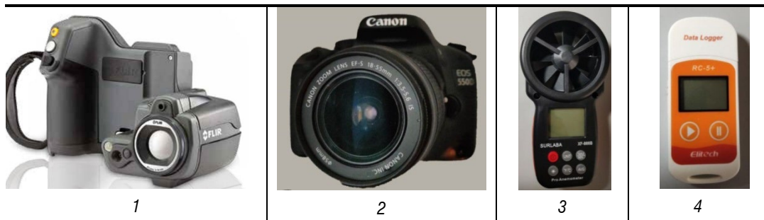
Figura 14 – strumenti utilizzati per la fase di rilievo: termocamera (1), macchina fotografica reflex (2), anemometro (3), termometro (4).
