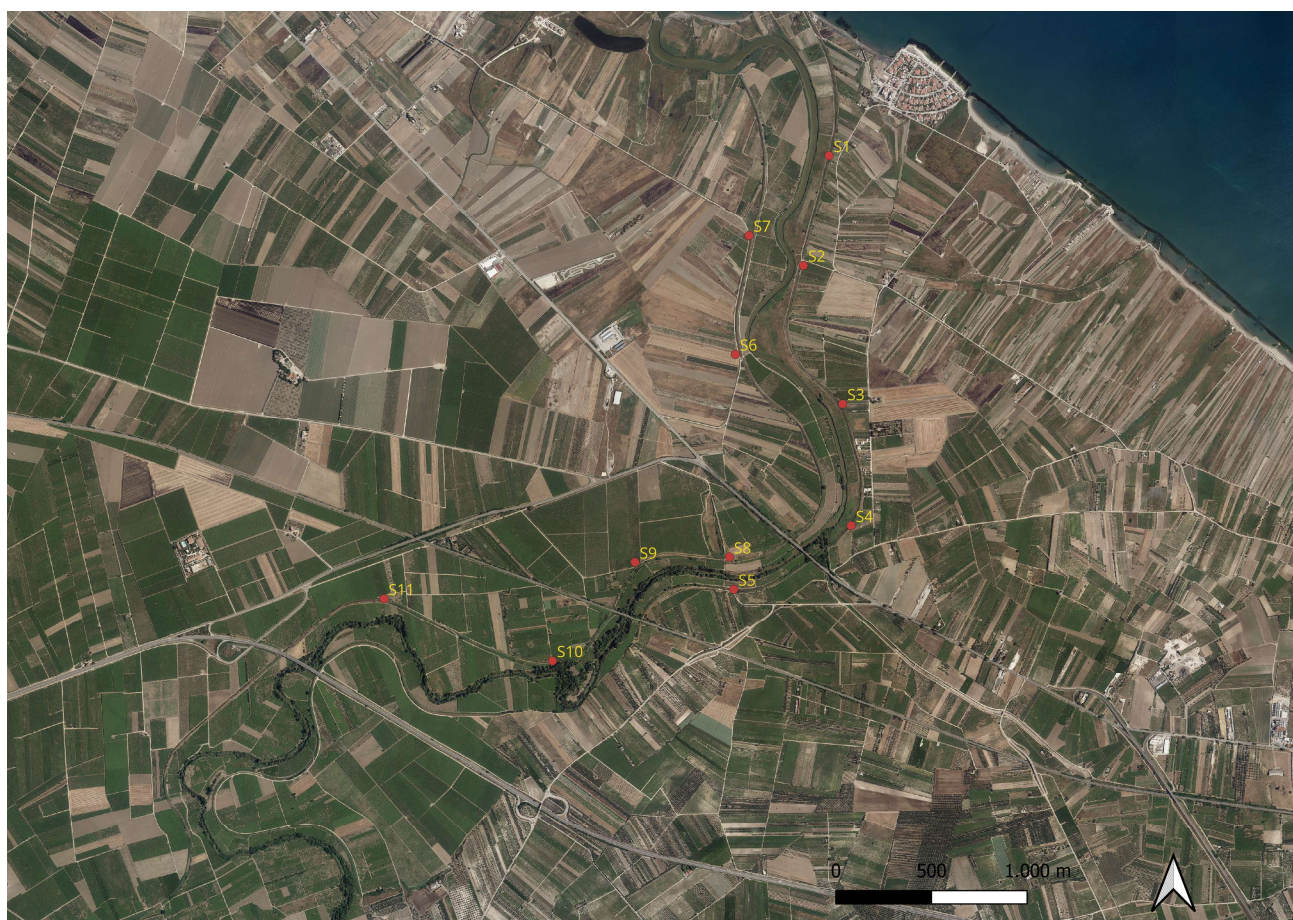
Figura 3– Sondaggi eseguiti nel 2014 nell’ambito della Progettazione preliminare degli interventi di mitigazione del rischio idraulico nel tratto terminale del Fiume Ofanto tra Ponte Romano e la Foce – 1° stralcio.
