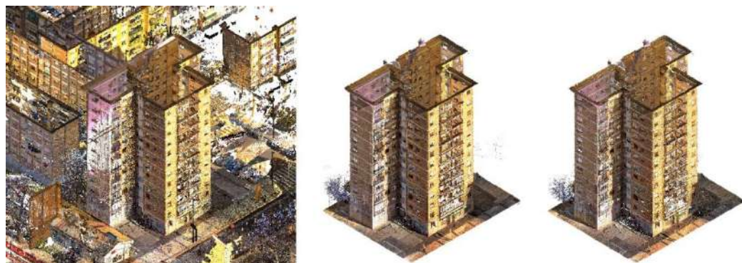
Fig. 71 - Comparazione tra nuvola di punti grezza, ritagliata manualmente e decimata.
