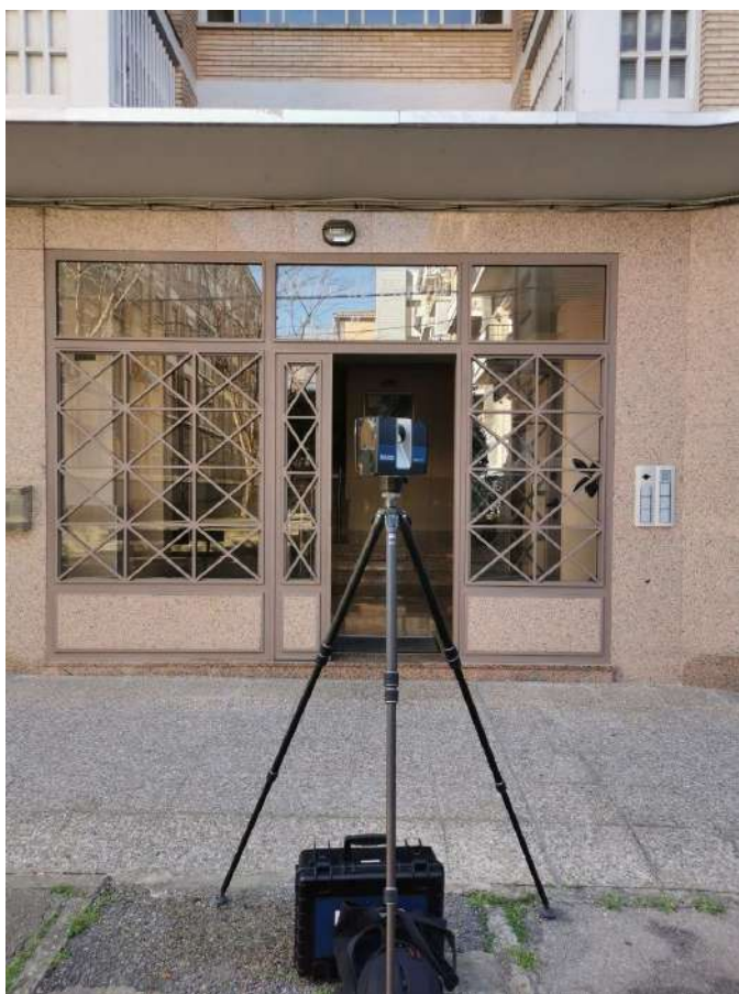
Fig. 69 - Operazioni di rilievo laser scanner presso il Conjunto Balsas de Ebro Viejo a Saragozza.
