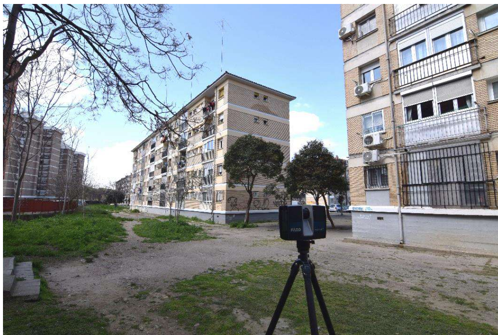
Fig. 70 - Operazioni di rilievo laser scanner presso il Conjunto Balsas de Ebro Viejo a Saragozza.
