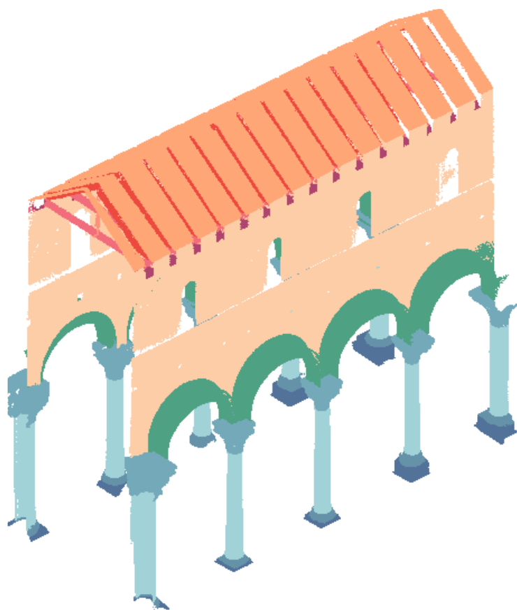
Fig. 32 - Segmentazione di nuvola di punti effettuata tramite algoritmo Random Forest. (Musicco, Buldo, Rossi, et al., 2024)
