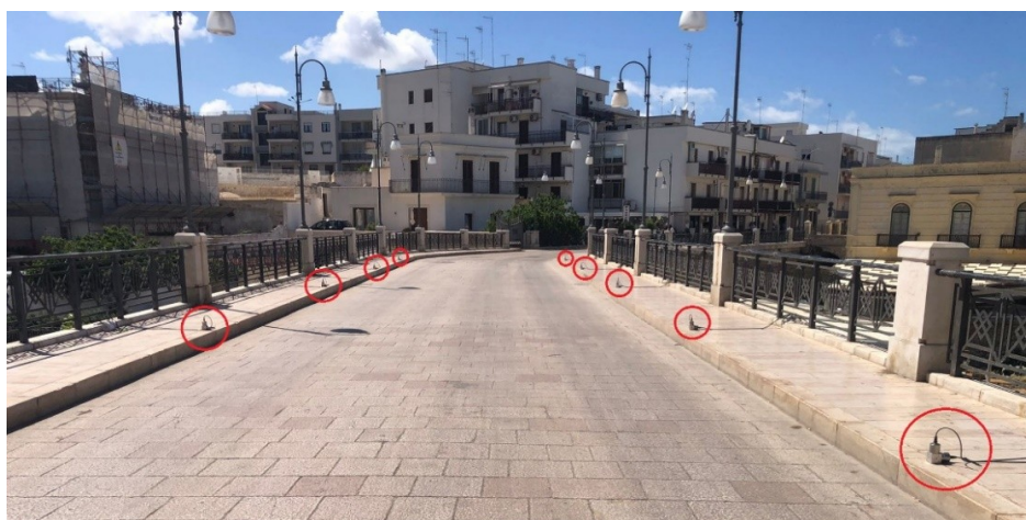
Figura 5.8: Posizione accelerometri sul marciapiede
