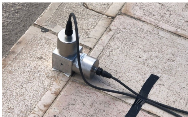
Figura 5.9: Accelerometro orizzontale e verticale posizionati in corrispondenza del cubetto di supporto
