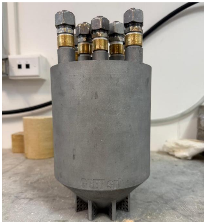
Fig.45 - Prototipo del Geoscambiatore innovativo realizzato da GEET srl in lega di alluminio.
