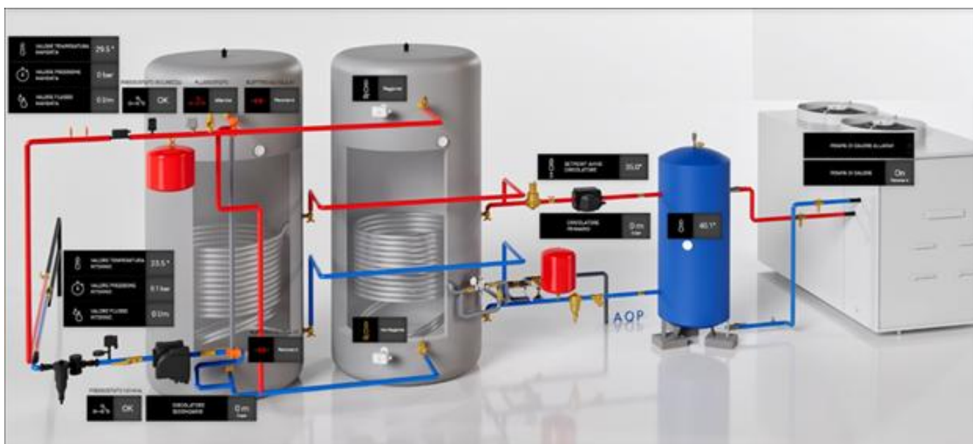
Figura 43 - Sistema di monitoraggio e controllo dei processi a distanza.
