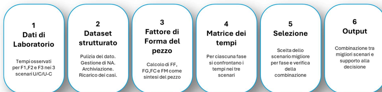
Figura 17. Logica di funzionamento del sistema
