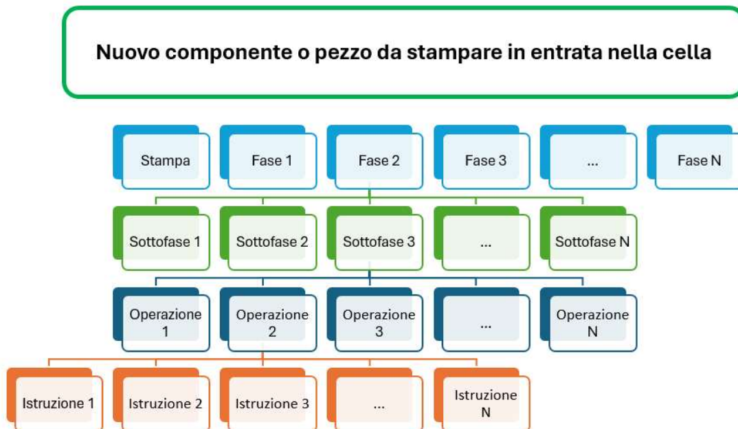
Figura 35. Struttura scomposizione massima del processo
