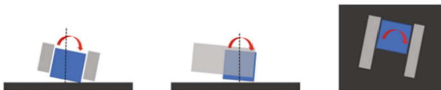
Figura 58. Immagine rappresentativa di una presa con accelerazione rotazionale non parallela letto di stampa [116]
