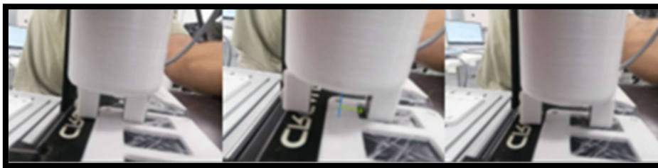
Figura 67. Complicazioni presa con cobot e studio criterio stacco
