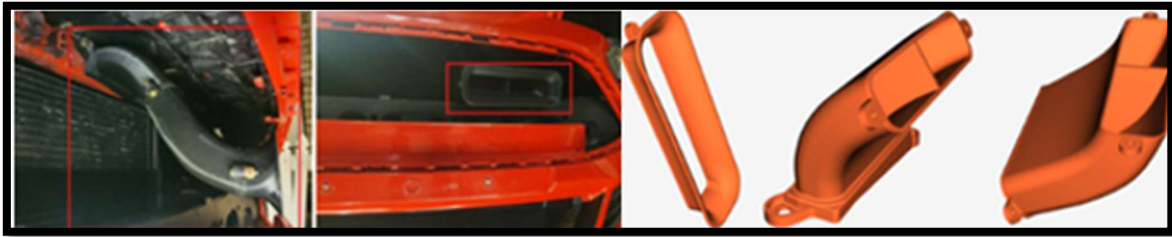
Figura 79. Illustrazione generale Snorkel aspirazione aria
