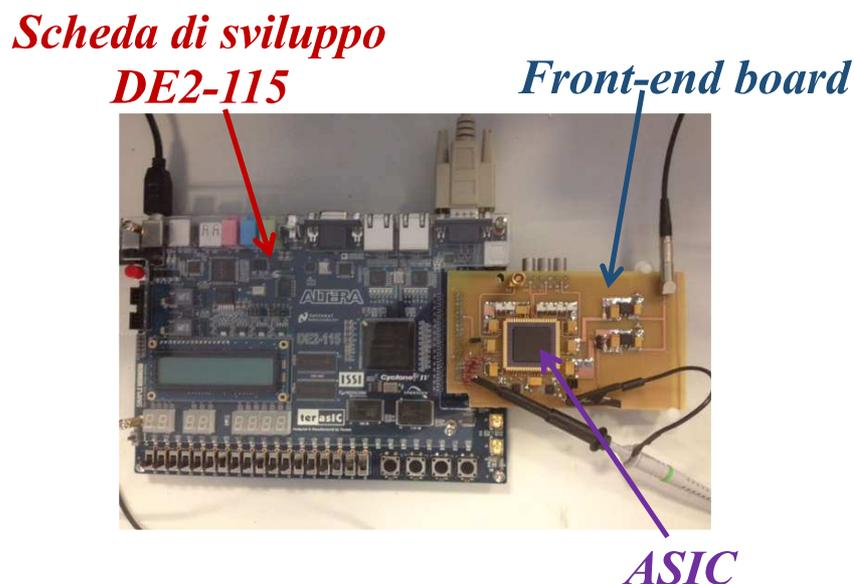
Figura 4.1: *Setup* utilizzato per il collaudo dell'ASIC
