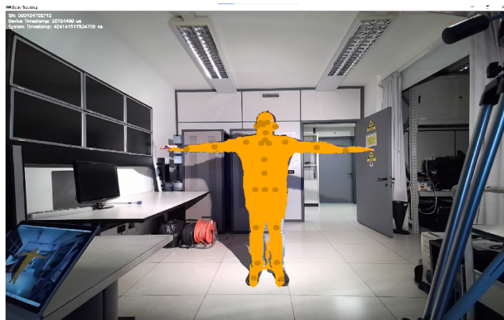
Figura 3 - Risultato del Body Tracking dell'acquisizione Sk(N, w/o, 1750, 2) . I punti arancioni rappresentano la posizione stimata dei giunti dello skeleton nell'immagine 2D.
