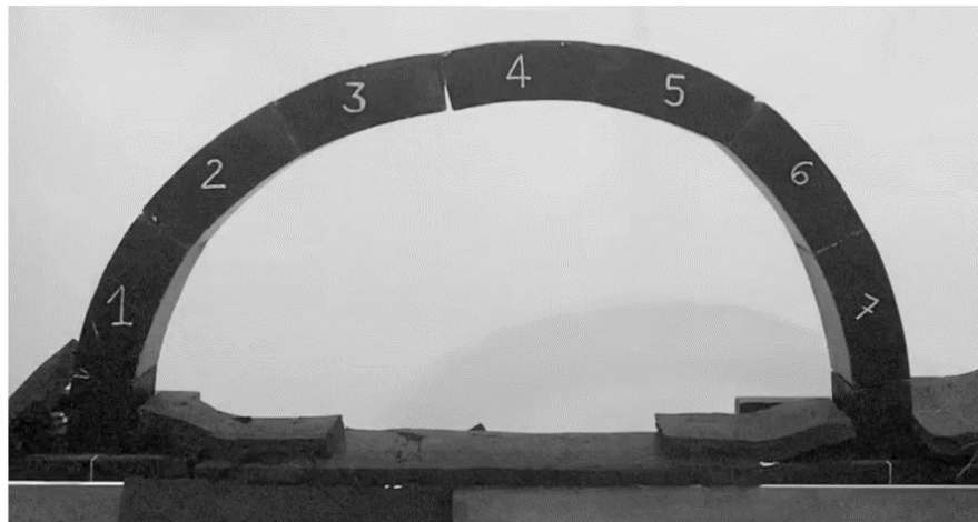
Fig. 87 - Fermo immagine del meccanismo ad arco a quattro maglie formatosi durante le prove dinamiche nel modello A
