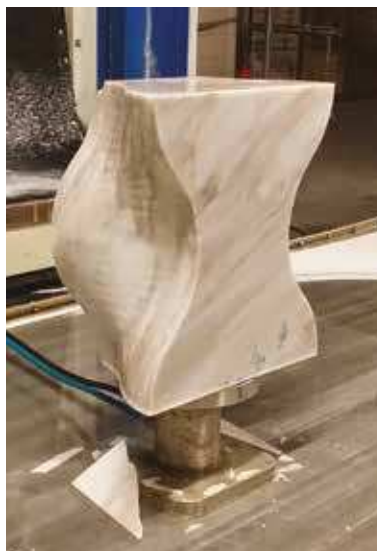
Figg. 115-116. L'Osteomorphic Catenary Arch e il singolo conco realizzato in marmo realizzato dall'azienda Generelli nel 2015 (© Giuseppe Fallacara).
