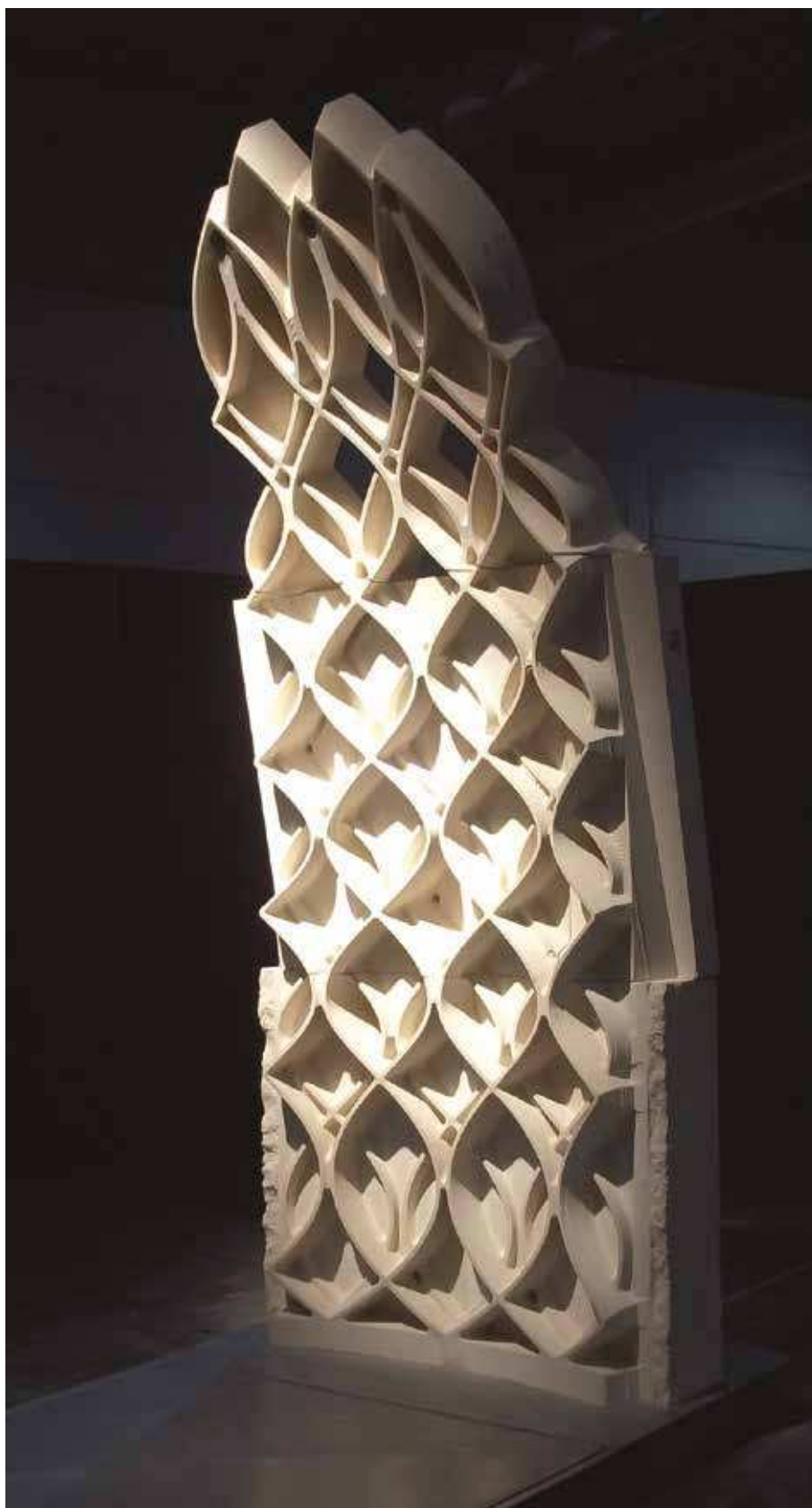
Fig. 15. Porzione in scala 1:5 della cupola della chiesa dei Ss. Cirillo e Metodio a Marino, progettata da Giuseppe Fallacara, Francesco Scricco e Graziella Fittipaldi ma non realizzata. Il prototipo, realizzato con macchine a controllo numerico, è stato esposto alla mostra 100% Gravity , in occasione del Marmomac 2012 (© Francesco Scricco).
