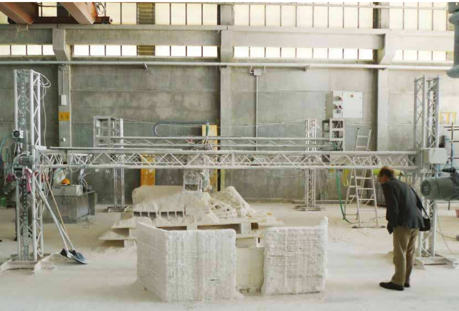
Fig. 35. La stampante D-Shape di Enrico Dini (© D-Shape, ESA).
