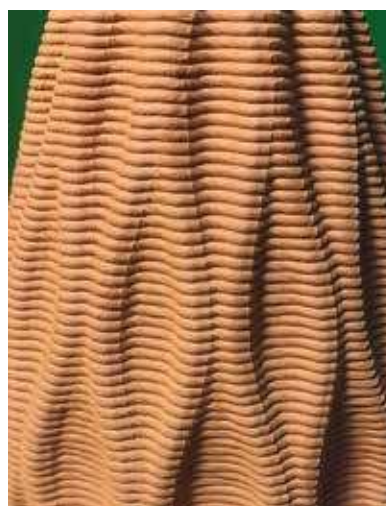
Figg. 40-41. Modello in scala di TechnoVault, progettato da Dustin White e stampato dall'azienda Concr3de con tecnologia binder jetting usando polveri di pietra leccese. Il modello è stato esposto presso la mostra Marmomac Meets Academies 2023 (© Gaz Blanco).
