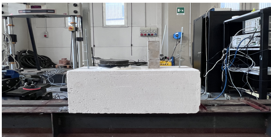
Figura 5.12: Setup sperimentale: vista frontale del provino RB_02 su base in cls autoclavato
