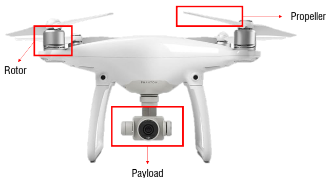
Fig. 59 - Drone (UAV) components. Phantom 4 DJI (DJI, 2024).
