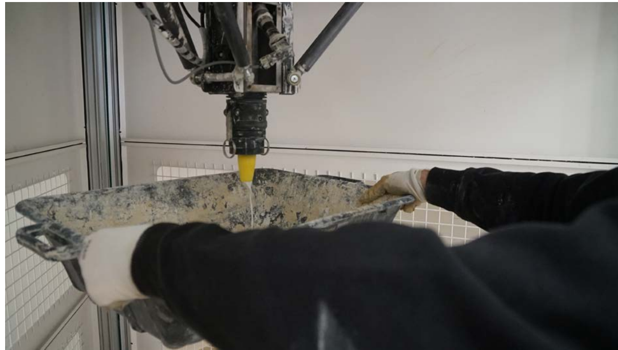
Fasi di carico dell'impasto nel sistema di estrusione della stampante
