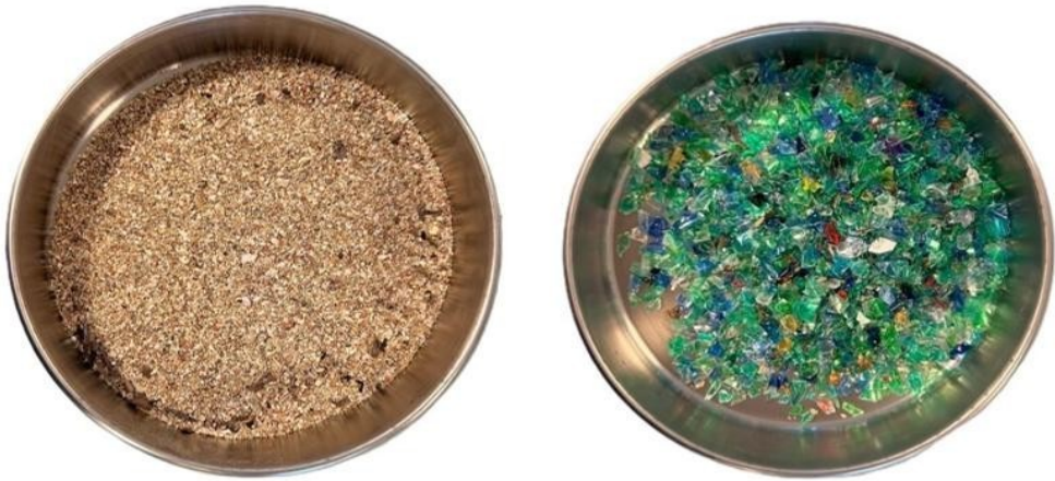
Figure 15- Mix 2 Sand D < 1\text{mm} ; PET 2\text{ mm} < D < 5\text{ mm}
