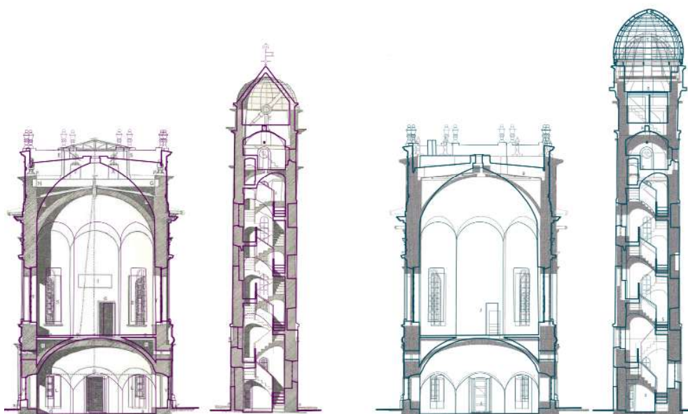
Fig. 26. El levantamiento Escáner láser comparado la planimetría del edificio del observatorio astronómico, donde se hace evidente la diferencia de altura de la torre y generatrices de las bóvedas del edificio, parapetos escaleras y espacios de la torre (Autor, 2023).
